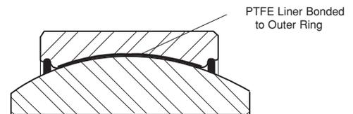
**Figure 8: Maintenance-Free Bearings**
